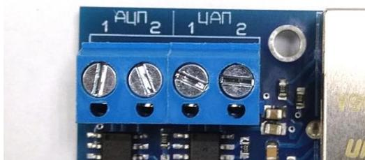
Измерение напряжения, а также генерация напряжения происходит относительно общего провода контроллера (минус на клеммной колодке питания) и не имеет оптической развязки, только защиту от статики. Диапазоны измеряемых и генерируемых напряжений – от 0 до 10 вольт.
