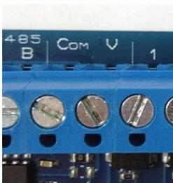
Начальное состояние каждого выхода принимается за логический 0, при превышении напряжения 3,5 вольт относительно клеммы «COM» происходит переход входа в логический 1.
